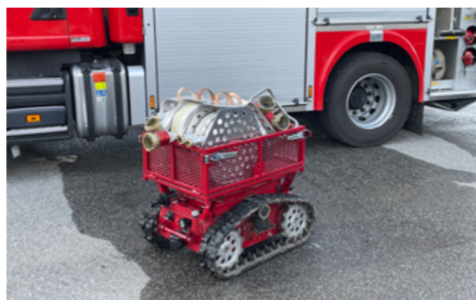
7. Fumo redo för utläggning av brandslang.
